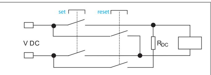
Der Wert für den Entregungswiderstand  $R_{DC}$  ist den Spulendaten, AC/DC Ausführung bistabil, zu entnehmen.
