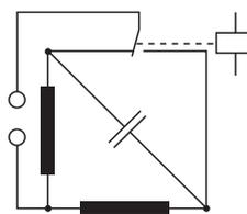
**Errónea inversión de giro motor en AC:** El contacto está en la posición intermedia menos de 10 ms: éste tiempo es insuficiente para permitir al condensador que descargue la energía antes de que se invierta la polaridad.
