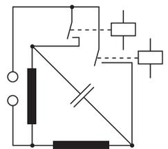
**Correcta inversión de giro motor en AC:** Prever un tiempo de pausa de 300 ms durante el cual ninguno de los contactos está cerrado: de este modo la energía del condensador se descarga a través de las bobinas del motor.
