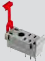
Montaje en circuito impreso
